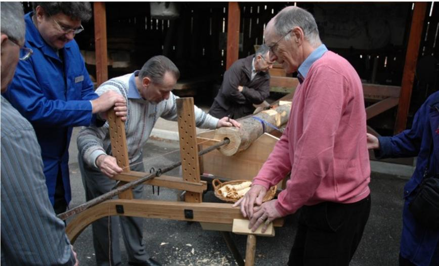
Fig. 9.6 : Manifestation organisée dans le cadre d'une exposition sur les sources, au cours de laquelle un tronc de pin est percé à l'aide d'une foreuse provenant des collections du musée. Autrefois, ces tuyaux en bois servaient à capter l'eau de source.
