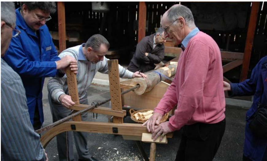
Abb. 9.6: Veranstaltung im Rahmen einer Quellenausstellung, bei der mit einem Teuchelbohrer aus den Museumsbeständen ein Föhrenstamm durchbohrt wird. Früher dienten diese Teuchel zur Herleitung von Quellwasser.
